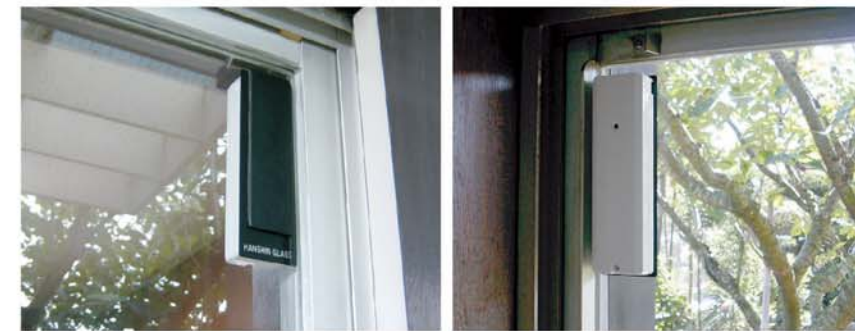
ガラスが割れたら無線で室内に設置したWSN本体に発報、ルーターからインターネットで携帯電話に異常を通報する(室内側に装着したガラス割れセンサーと発報装置)
